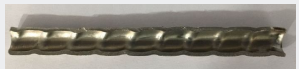
Imagem da superfície interna de um tubo corrugado.
