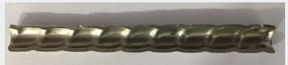
Imagem da superfície interna de um tubo corrugado.
